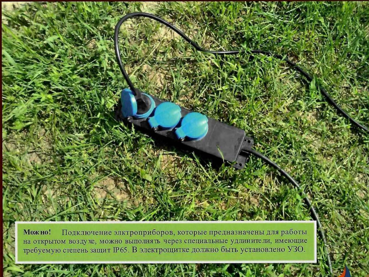
**Можно!** Подключение электроприборов, которые предназначены для работы на открытом воздухе, можно выполнять через специальные удлинители, имеющие требуемую степень защиты IP65. В электрощитке должно быть установлено УЗО.
